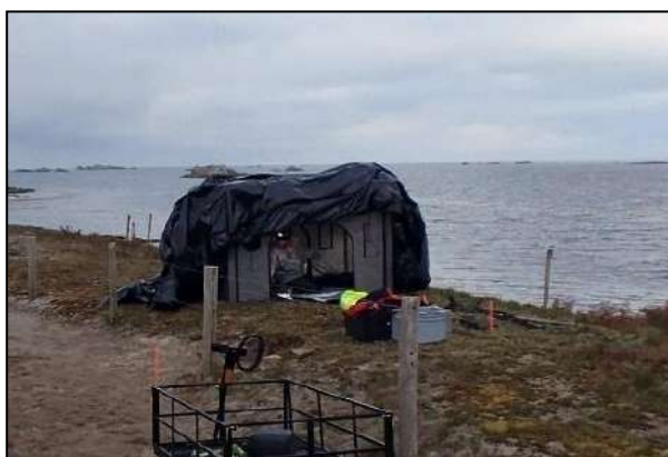
Photos : chambre noire permettant l'échantillonnage du sédiment en vue d'une datation OSL . © G.Stéphan 2024 IUEM
