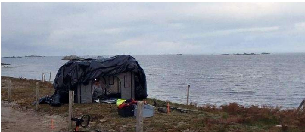
Figure 1 : chambre noire permettant l'échantillonnage du sédiment en vue d'une datation OSL
