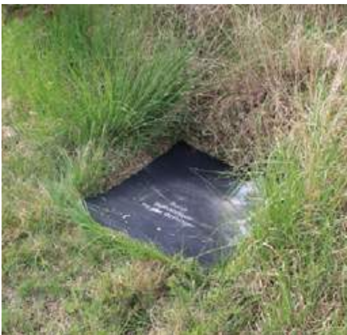
Plaques de chauffe, instrument du POPReptile
